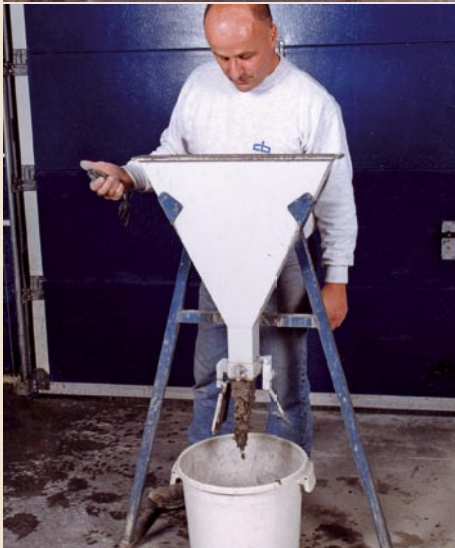
• Meten van de vloeimaat (boven) en de trechtertijd.
